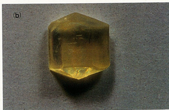
図3 DIVA単結晶の例(a)昇華法による板状結晶と(b)溶媒蒸発法によるバルク結晶
