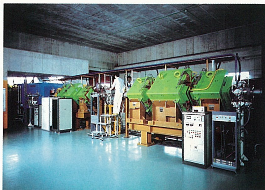
図3 1989年秋に完成した不安定核生成装置RIPS。エクゾティック核の研究がこの装置により行われる。
