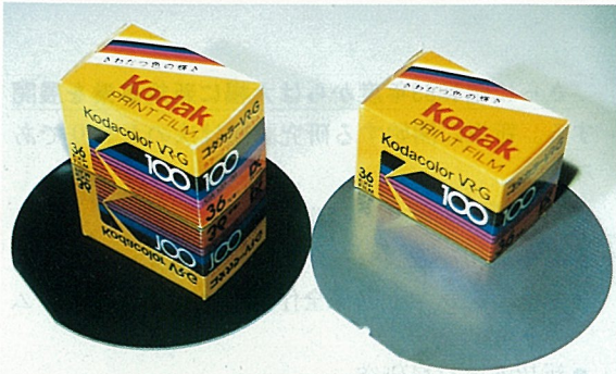
図3 シリコンウェハ(通常研削と鏡面研削加工例)
