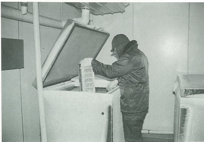
微生物の種培養は -80^{\circ}\text{C} の超低温槽あるいは -196^{\circ}\text{C} の液体窒素を用いて凍結保存する
