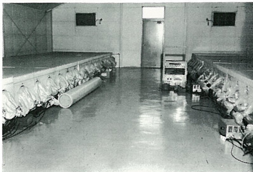
第7図 理研板橋の中性子観測装置。円筒のものが中性子計数管。角型のはポリエチレン板で囲んだもの。中に5 cm厚の鉛円筒。その中に計数管。
