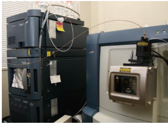
図3 当センターが保有する質量分析計 分子量で特定の物質を分離する装置。植物ホルモンの量は、植物中に含まれるほかの物質（糖や脂質、アミノ酸など）の1万～10万分の1程度。ストリゴラクトンは特に少なく質量分析計による高感度な検出が功を奏した。
