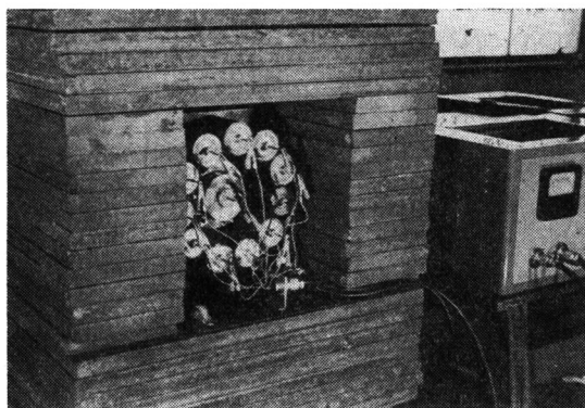
鉄の厚さ20センチの箱の中におさまられた ガイガー計数管
