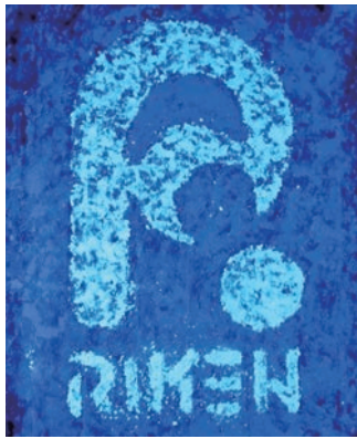
図24 圧力を受けると蛍光色が青色に変化する固体有機色素
