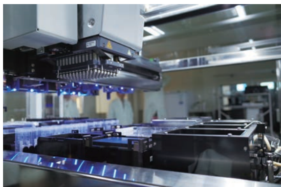
図13 ncRNAの機能を網羅的に解析するロボット
