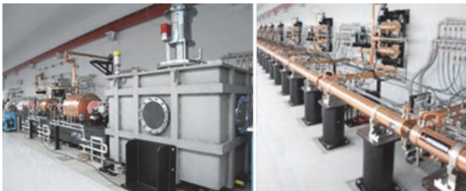
図3 SACLAの電子銃（左）と加速器（右） 電子銃から放出された電子が、加速器で光速近くまで加速される。
