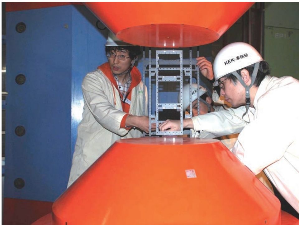
図37 理研とKEKによりJ-PARCハドロン実験施設にE16スペクトロメータ電磁石が完成 中にGEMトラッカーフレームの設置を行う小松雄哉、菅野光樹、四日市悟（左より）。
