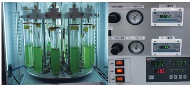
図19 独自に開発したCO 2 濃度、光環境の完全制御による回転藻類培養装置
