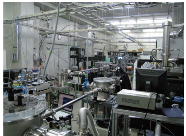
(上) 世界最高強度のアト秒パルスが発生させるための励起レーザーシステム (下) アト秒領域での非線形現象を観測するためのビームラインと計測装置
