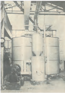
アドソールを用いた 除湿装置
