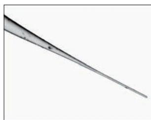
図3：1 μmの超微細マイクロ工具
