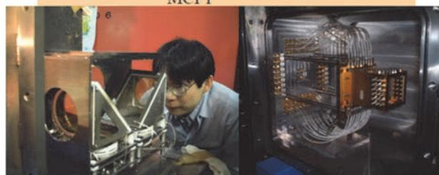
飛行時間検知型質量分析器 (左)
