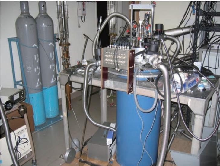
図20 ナノ構造の電子のトランスポートの実験をするための希釈冷凍装置
