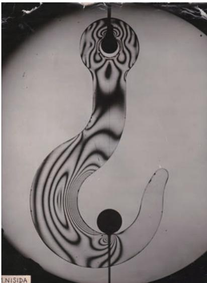
図9 フックの応力分布を示す光弾性縞
