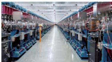
SACLA内部 真空封止アンジュレータ
