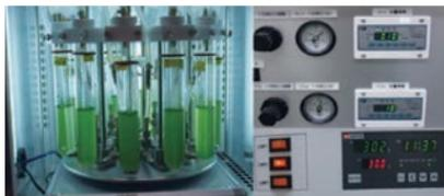
生産効率で世界最高レベルを達成。CO<sub>2</sub>濃度、光環境の完全制御による回転藻類培養装置。
