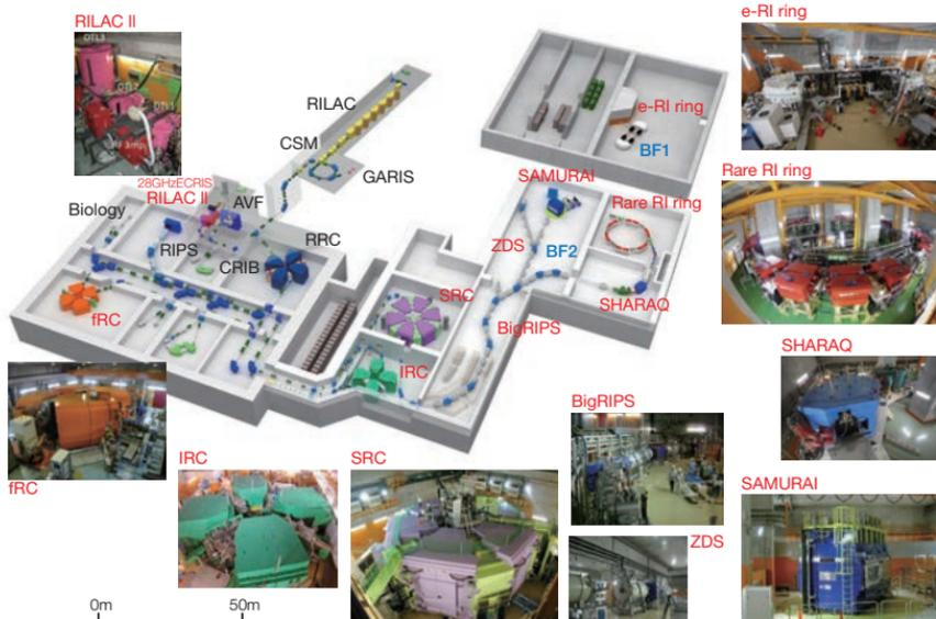
水素からウランまでの全元素を加速し、さまざまな標的要素に衝突させて発生する不安定原子核の性質を調べることができる世界最高性能の装置。ここでしかできない実験を行うために、世界中から研究者が参集する。
