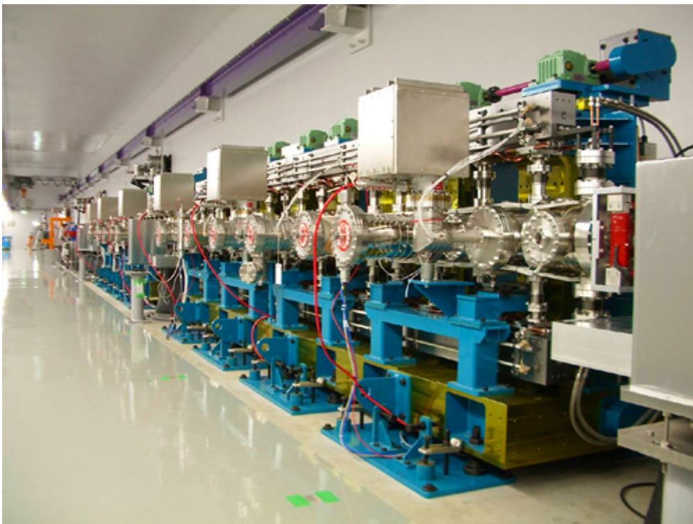
図 8:真空封止アンジュレータ。銀色の円筒の中に磁石列が入っている。
