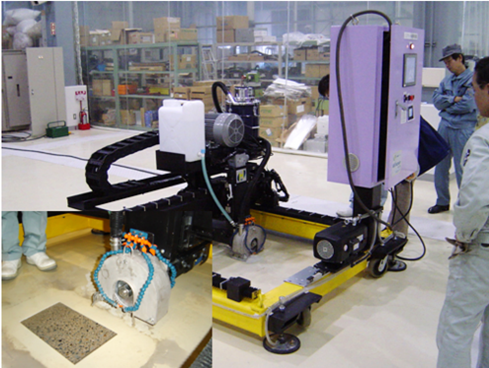
図 5:床研削を行う「ゆかとけんさく」。左下のように、長形状に研削する。
