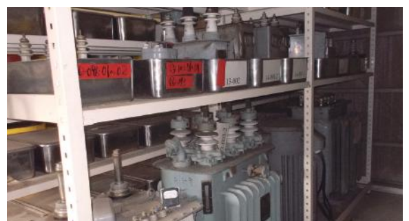
漏洩対策などの措置を行い保管しているPCB含有廃棄物保管庫
