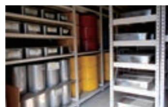
漏洩対策などの措置を行い保管しているPCB含有廃棄物保管庫
