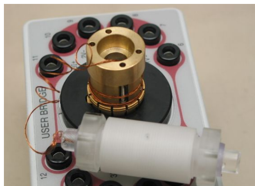
図 1: ダンベル型試料棒を装着した樹脂製引張り治具
