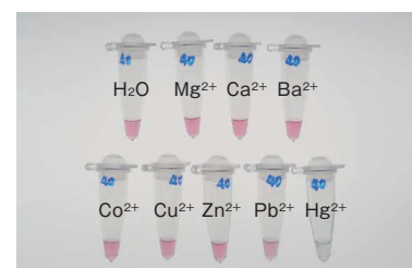
● 図2 2本鎖DNAを固定した金ナノ粒子の凝集の有無を利用した水銀イオンの目視検出
